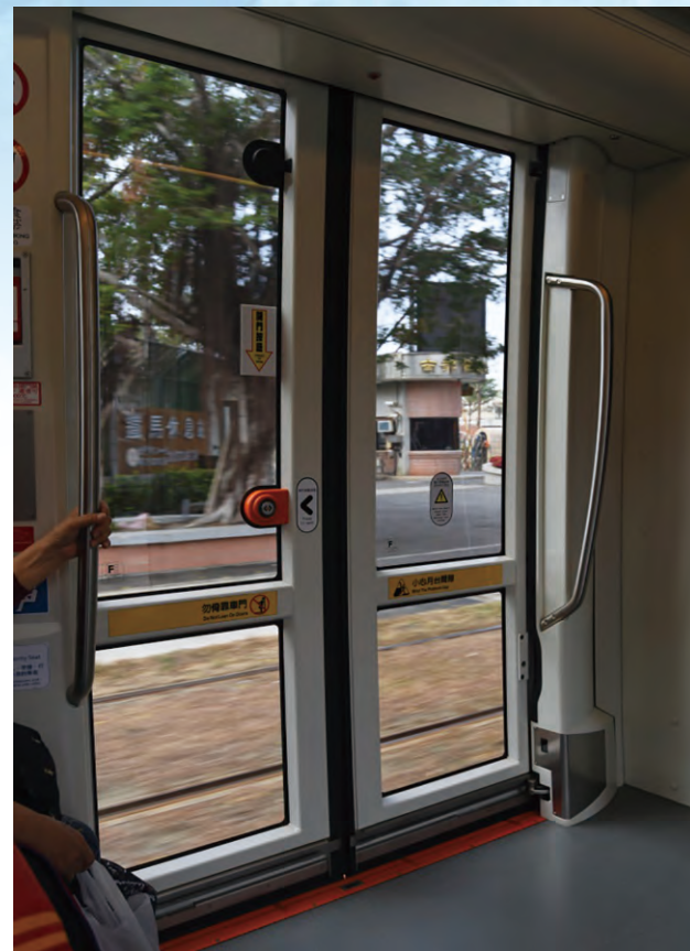
車門內外側皆設有「開門按鈕」(照片中橘色部分), 跟北捷的自動門設計很不一樣
