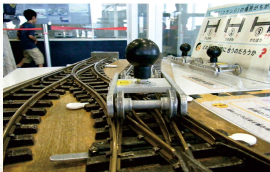
輪緣於內側之2號車，可通過正確的道岔開通方向，順利由起點到達終點
